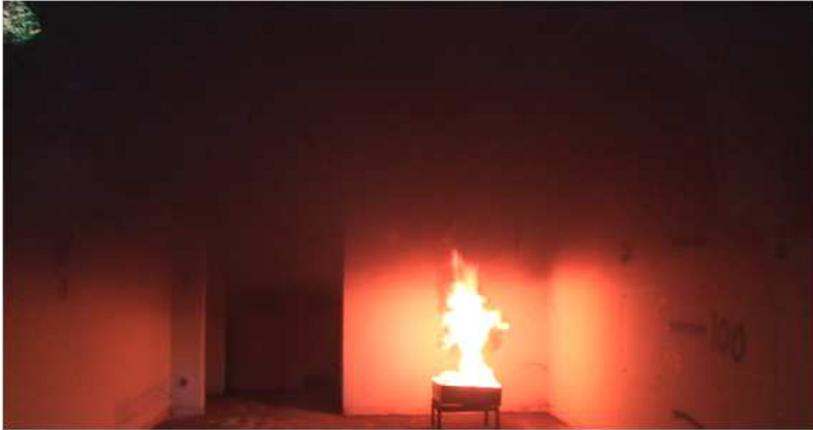
Abbildung 1: Das Brandgeschehen 60 Sekunden nach der Entzündung der brennbaren Flüssigkeit beim Versuch 1. Die Aufnahme wurde vom angrenzenden Balkon aufgenommen.
