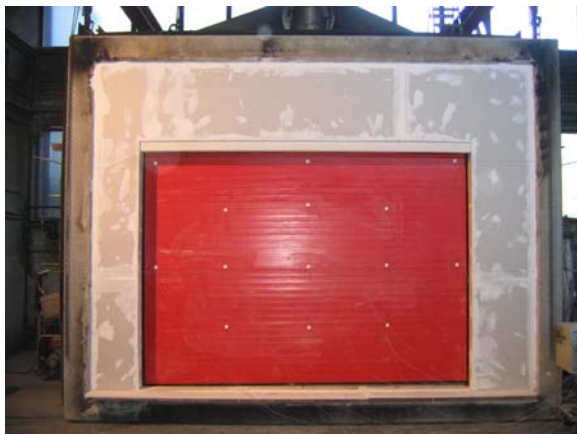
Das Rolltor vor der Brandprüfung
