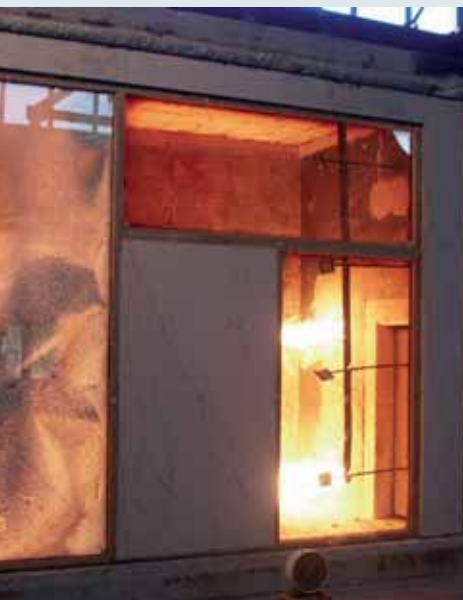
Bauteilprüfung an Tür, Fensterkonstruktion aus Holz.
