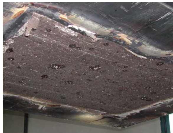
Abb. 11: Untersicht Versuchskörper VK23 2-lagige Bewehrung mit Fasern
