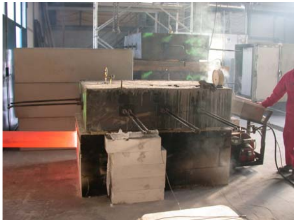
Abb. 3: Vorspannung mit Spanngliedern
