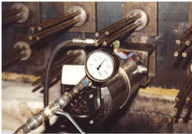
Abb. 6: Messung des Spannkraftverlaufs
