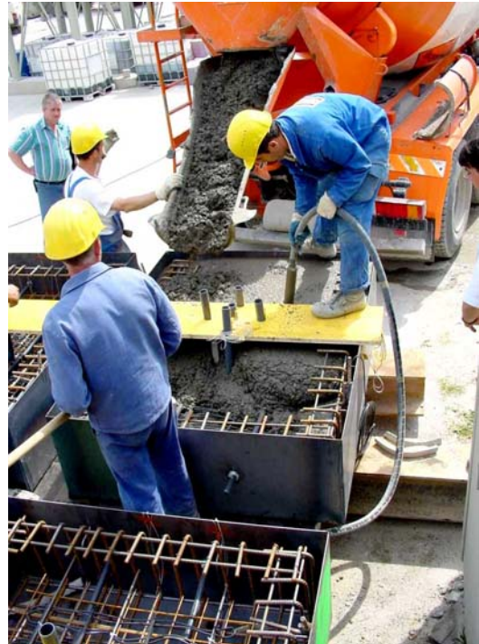
Abb. 2: Versuchskörper VK30 mit Druckmesssonden
