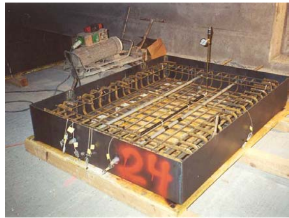
Abb. 7: Litze mit Fettdruckmessung
